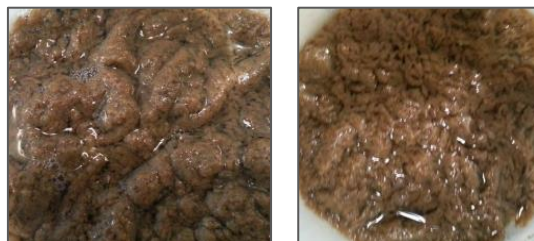
Flockenaufbau: links großvolumig, rechts kompaktiert
