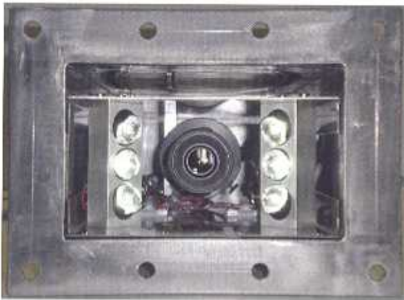
Bild 3. CCD-Optik und Leuchten (Gerät offen).
