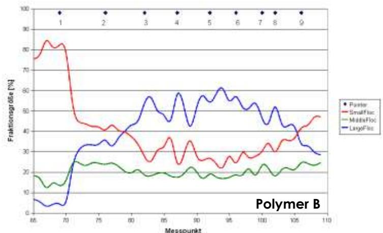
Im Diagramm mit Polymer B (rechts) fällt die Anzahl der kleinen Strukturen erst nach weiterer Polymerzugabe (Markierungen 2-4) deutlich ab. Reziprok steigen die Fraktionsgrößen der großen Strukturen (blau) an.
