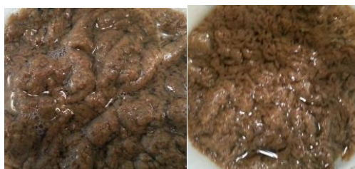
Flockenaufbau: links großvolumig, rechts kompaktiert
