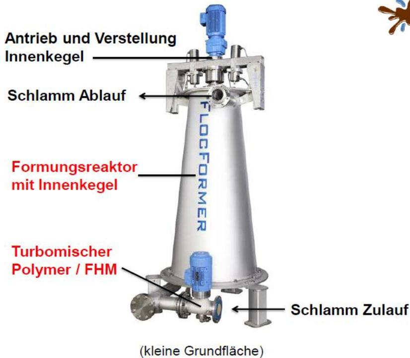
Bild 1: FlocFormer zur zweistufigen Konditionierung – 1. Einmischung und 2. Formung
